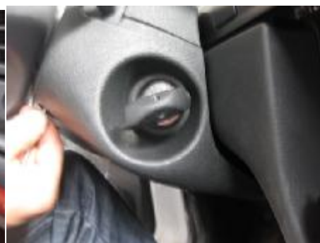
باز کردن پیچهای زیر قاب
