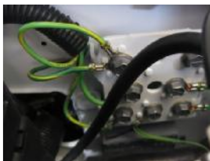
۲- محل قرار گیری یونیت فن (زیر چراغ جلو سمت راننده) ۳- صفحه اتصالات منفی سیم کشی موتور
