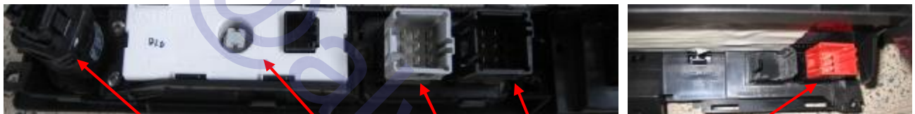
نمای از پشت: کلید قفل کن شیشه بالابر - کلید AC - فلاشر - ساعت و دماسنج - سنسور کولر اتوماتیک
